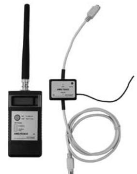
Die Funkübertragung der Feldstärkemesswerte ermöglicht, nach dem Ausschussverfahren durch Abklemmen von Koaxialleitungen die markante Leitung zu lokalisieren. Nachteil: Überschreiten mehrere Koaxialleitungen die Feldstärkegrenzwerte, so kann jeweils nur eine Leitung zugeschaltet werden, um die Leckstelle zu finden. Die anderen Anschlüsse haben dann kein TV, Radio und Internet.
