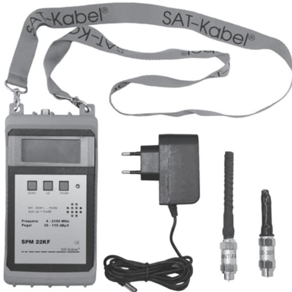
Störstrahlprüfset für Kennfrequenz 301 MHz
