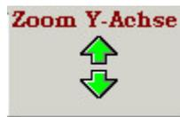
Mit den Pfeiltasten wird die Skalierung der Y-Achse verändert, so dass die Einteilung größer oder kleiner wird.
