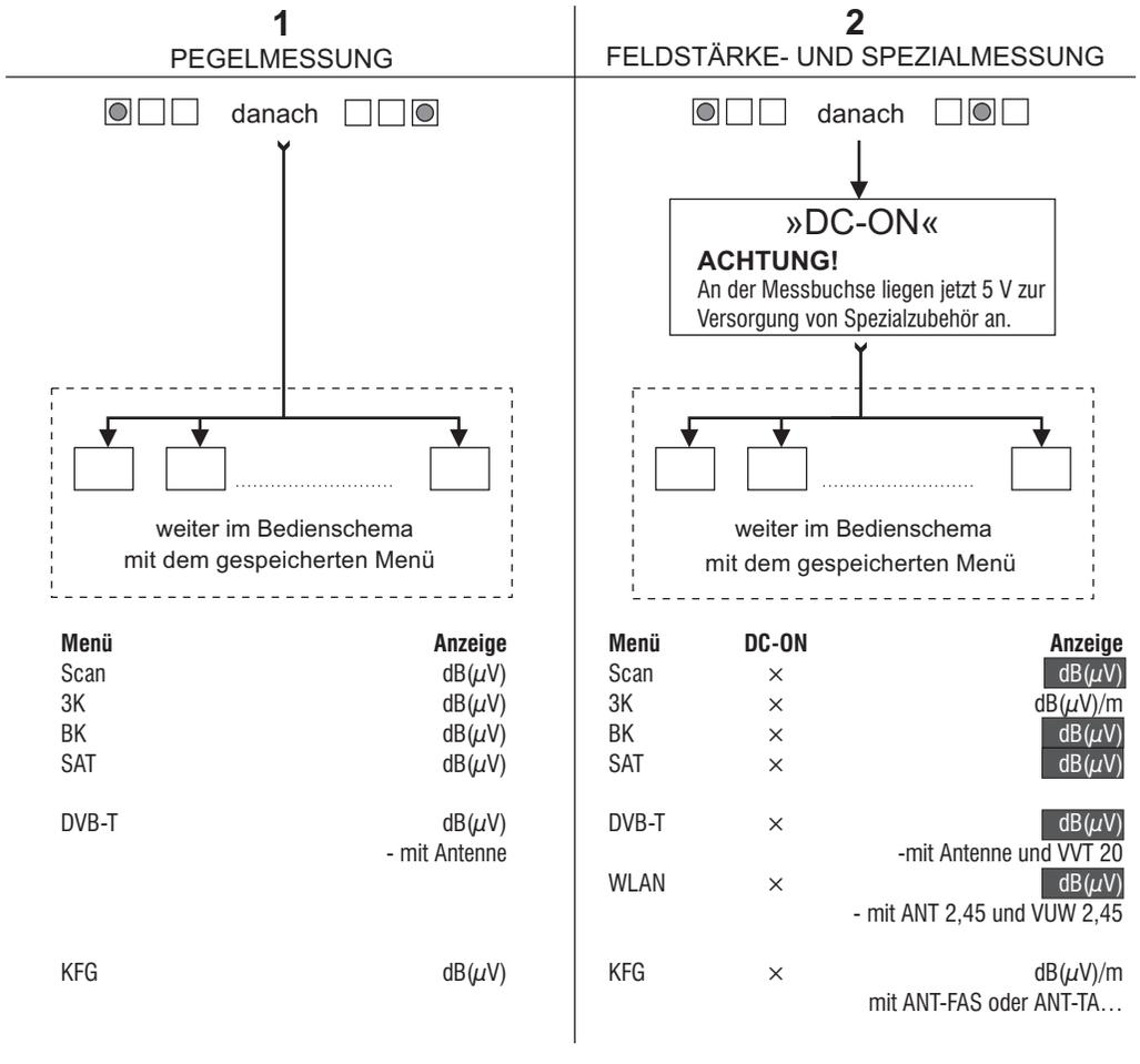
Nach dem Einschalten des Gerätes erscheint der zuletzt gespeicherte Messbereich im Display. Mit der Taste »up« oder der Taste »down« kann ein anderer Messbereich gewählt werden. Beim SPM 22 KF stehen folgende Bereiche zur Verfügung:
