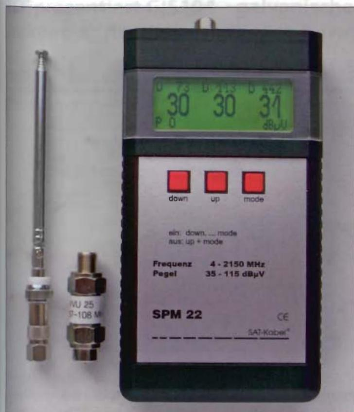
SPM 22 mit Vorverstärker und TK-Antenne
