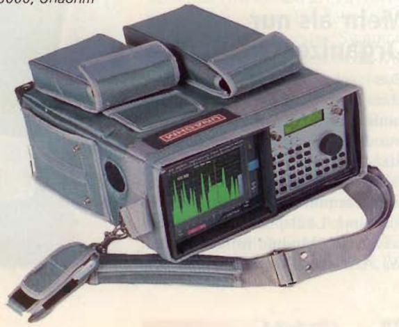
xisgerechten Hilfsgerät zur Fehler-suche und Pegelkontrolle in Sat- und BK-Anlagen.
