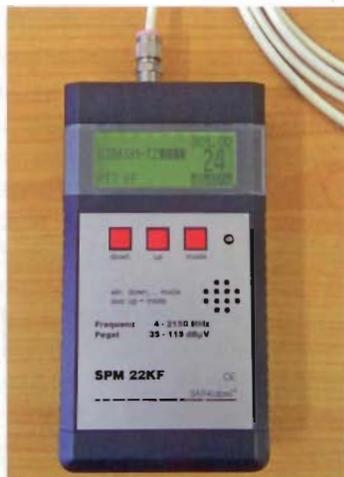
Bild 3: HF-Pegelmessgerät SPM22KF (Quelle: SAT-Kabel)
